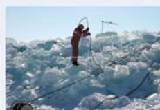
Термобурение ледовых образований
