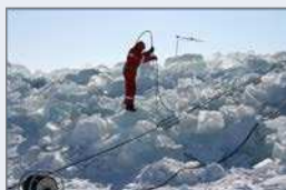
Термобурирование ледовых образований
