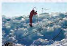
Термобурирование ледовых образований
