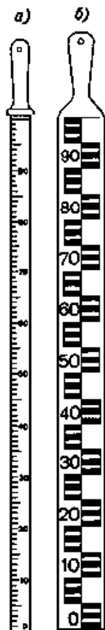
Рис.5. Переносные водомерные рейки:
