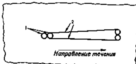
Рис.73. Устройство щели в ледяном покрове для пуска глубинных поплавков:
