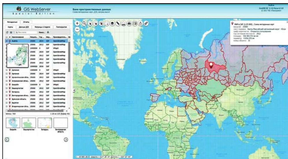
Рисунок 6.1 – Система хранения и обновления пространственных данных с автоматизированным формированием геопокровтий в ГИС «Панорама» (с сайта: https://gisinfo.ru/products/geodbse.htm )
