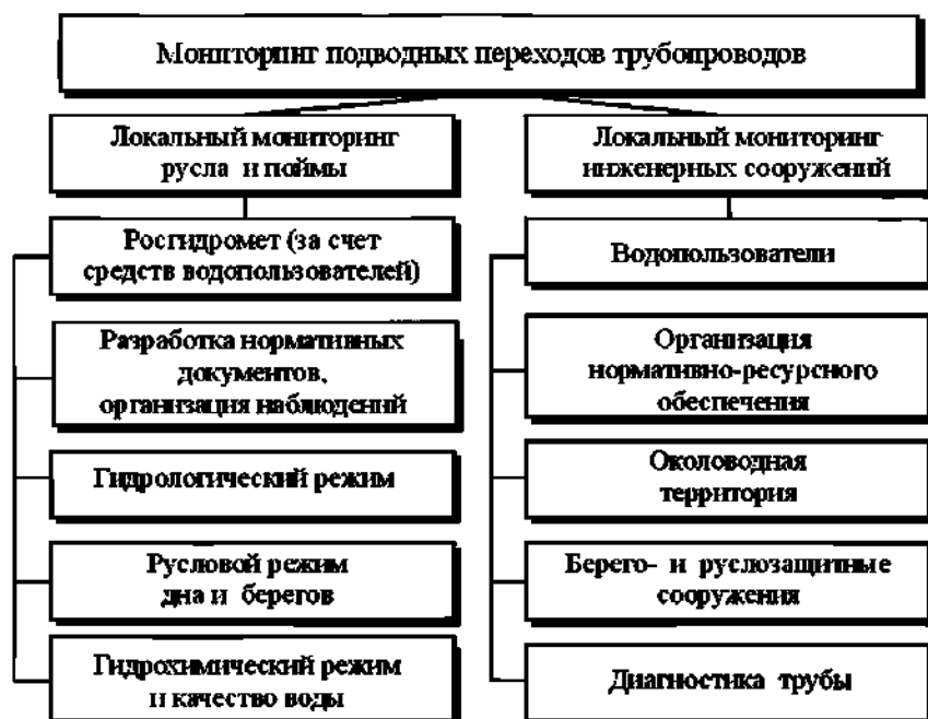
Рисунок 14.1 — Структура мониторинга подводных переходов трубопроводов
