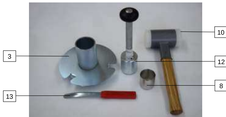
Рисунок А.2 – Общий вид комплекта для отбора проб почвы с помощью ударной рукоятки с открытым держателем
