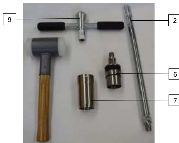
Рисунок А.3 – Комплект для отбора образцов из скважин
