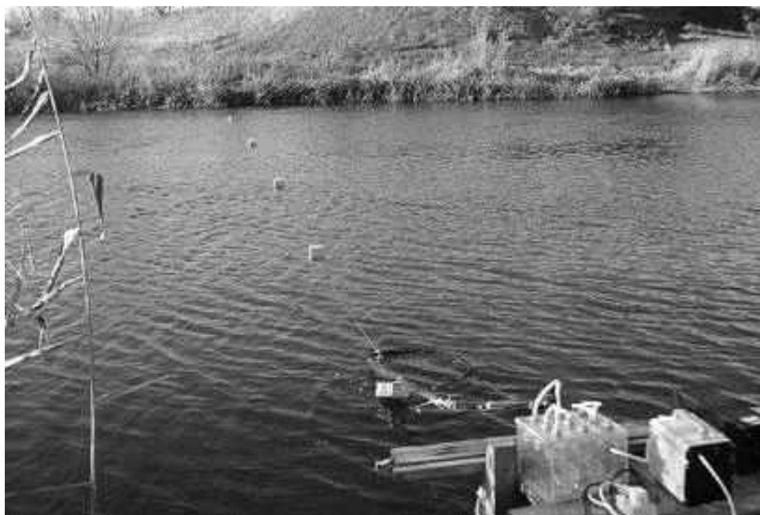
Рисунок 5 – Установка в створе для одномоментного отбора проб с вакуумным пробоотборником на реке Миус
