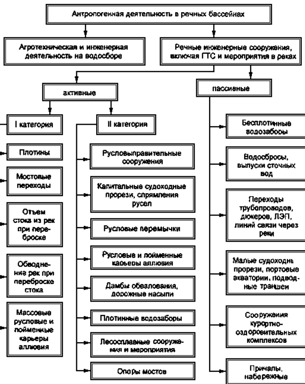
Рисунок 1 - Классификация речных инженерных сооружений, включая ГТС, и мероприятий по характеру взаимодействия с русловым процессом [4]
