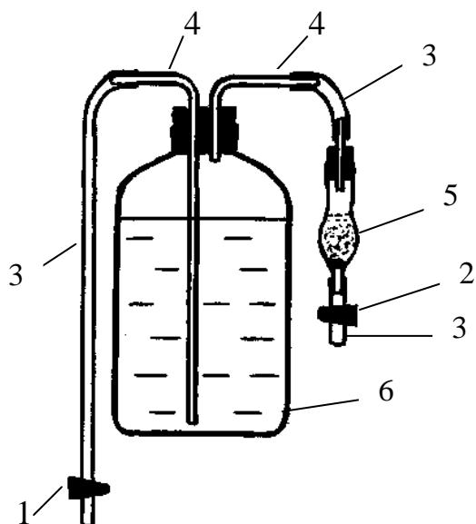
1, 2 – зажимы; 3 – резиновые (силиконовые) трубы; 4 – стеклянные трубы; 5 – хлоркальциевая трубка; 6 – пластиковый флакон
