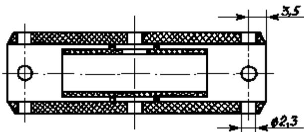
Рисунок 1 - Графитовые трубки с коаксиальной платформой
