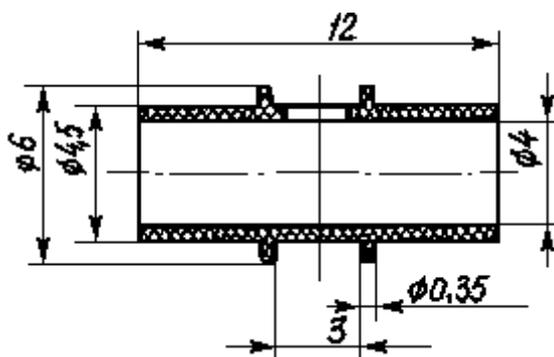
Рисунок 2 - Коаксиальная графитовая платформа
