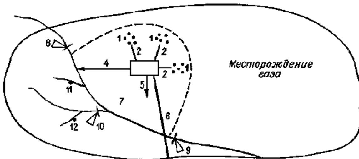
Рисунок 2 - Схема расположения створов отбора проб воды на участке реки
