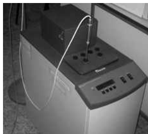
Рисунок В.1 – Установка для воспроизведения температуры тройной точки воды
