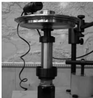
Рисунок Г.4 – Поршневая измерительная система рабочего эталона давления МП-6 класса точности 0,005
