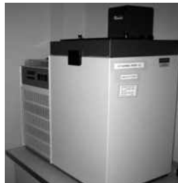
Рисунок В.2 – Установка для воспроизведения температуры плавления галлия
