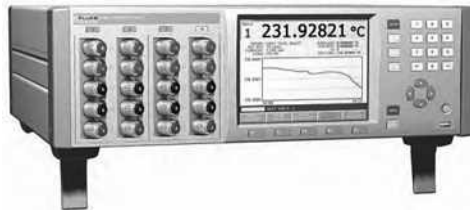
Рисунок В.4 – Внешний вид прецизионного термометрического моста «Fluke 1594»
