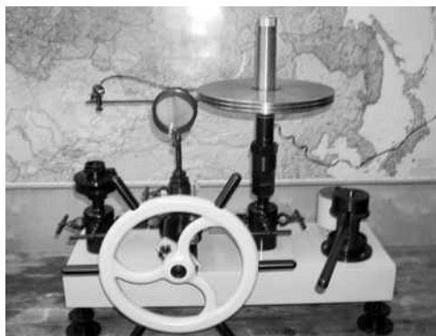
Рисунок Г.7 – Рабочий эталон единицы давления МП-600 класса точности 0,005
