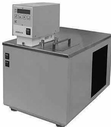
Рисунок В.5 – Циркуляционный низкотемпературный термостат KRIO-VT-03
