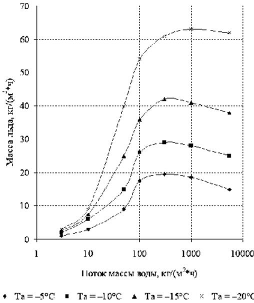
Рисунок 3.1 – Зависимость скорости нарастания льда на вертикальной стенке при брызговом обледенении от потока массы воды при различной температуре воздуха  $T_a$
