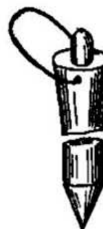
Рисунок 5.8 – Приспособление для установки нивелирных реек – костыль
