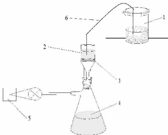
1 – проба воды; 2 – воронка для фильтрования; 3 – фильтр; 4 – колба Бунзена; 5 – вакуумный или водоструйный насос; 6 – трубки соединительные.
