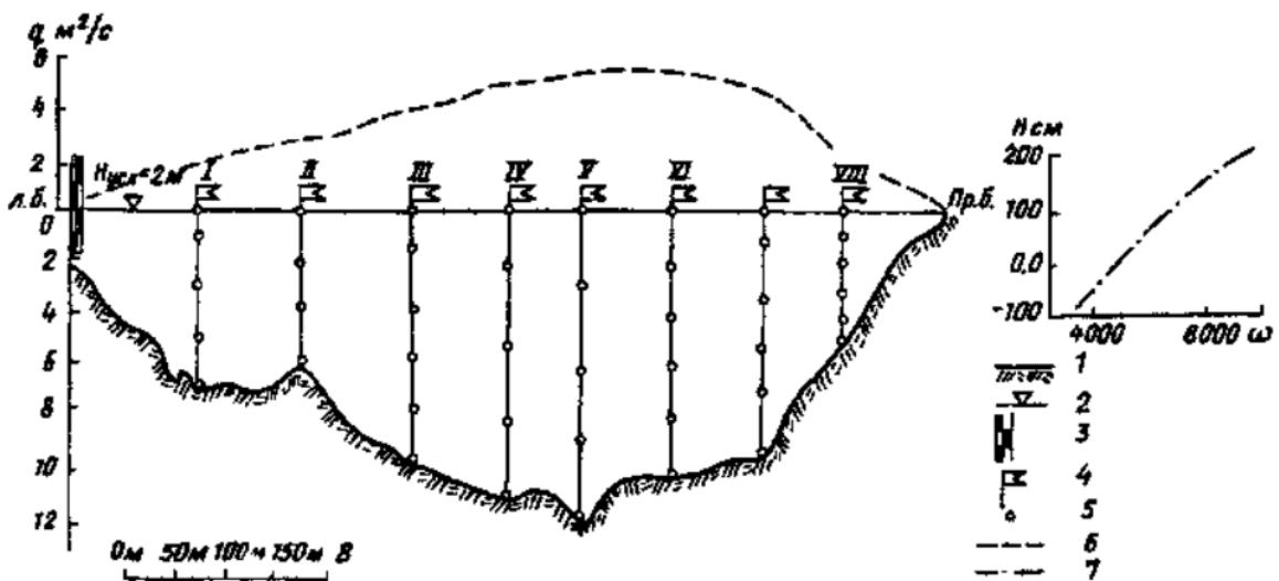
1-линия дна, 2-уровеньная поверхность, 3-водомерная рейка, 4-скоростные вертикали,
