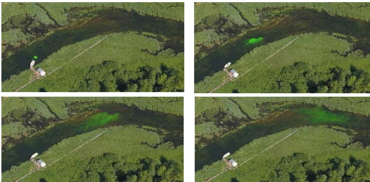
Рисунок 1 – Перемещение индикатора в потоке на примере пуска флуоресцентного вещества
