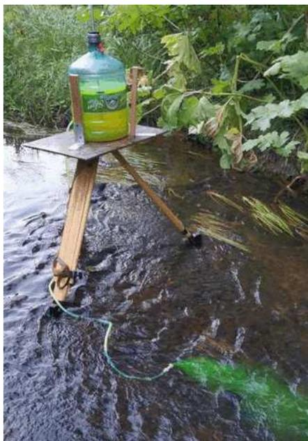
Рисунок 3 – Пример постоянного пуска солевого раствора, подкрашенного для наглядности
