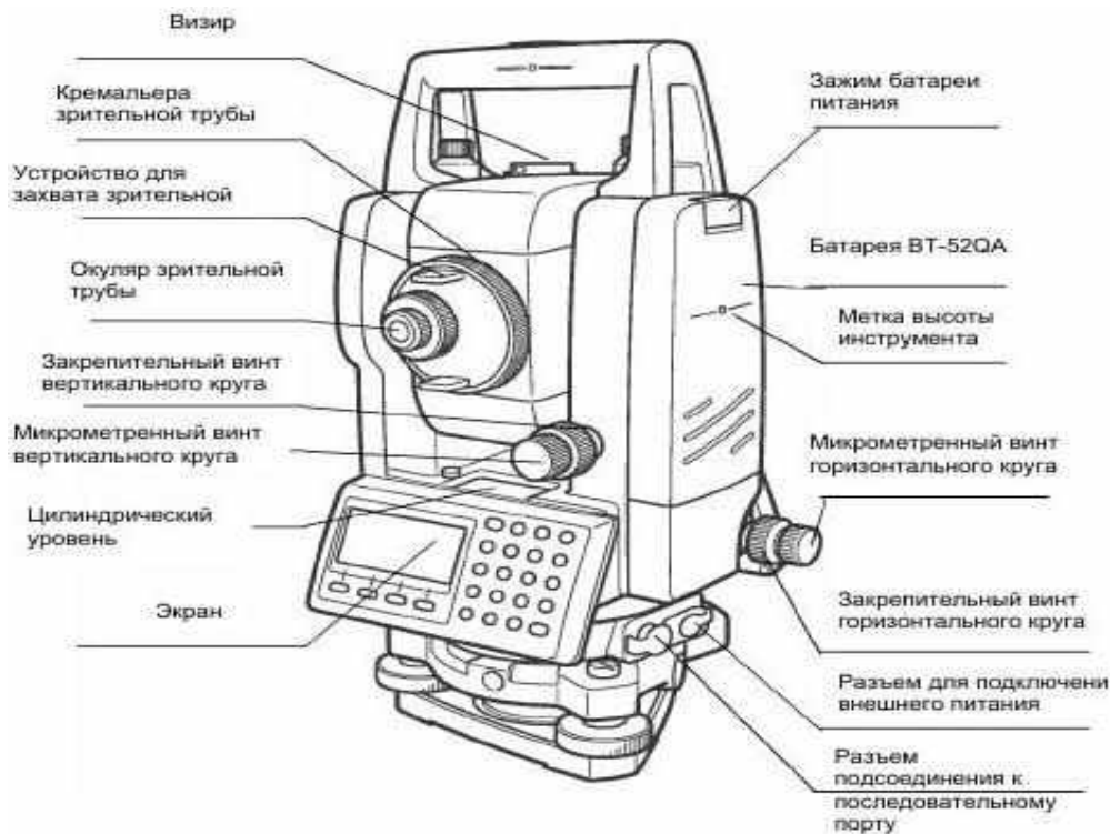
Рисунок Б.1 – Основные конструктивные элементы тахеометра
