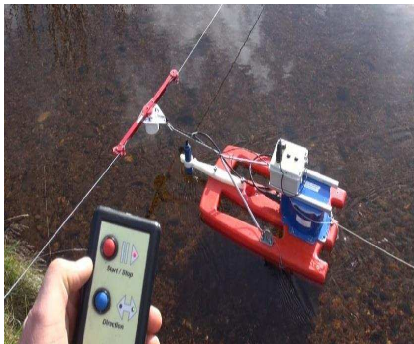
Рисунок 4 – Перемещение профилографа по перетяжке с помощью электрического тросохода
