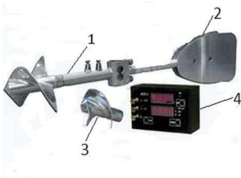
1 – вертушка; 2 – стабилизатор; 3 – сменный лопастной винт; 4 – преобразователь сигналов вертушки ИСО-1
