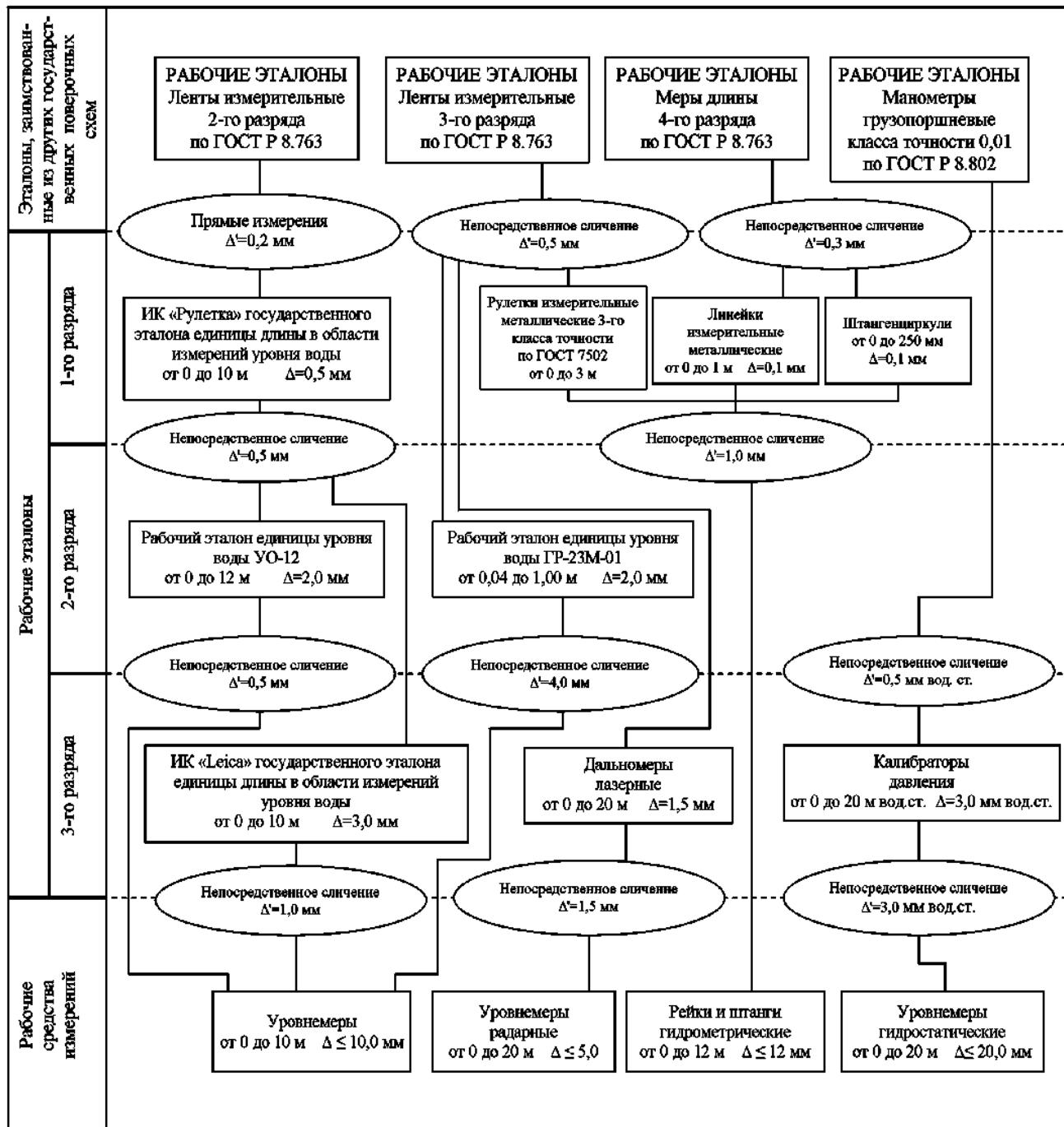
$\Delta$  - предел допускаемой абсолютной погрешности СИ;
