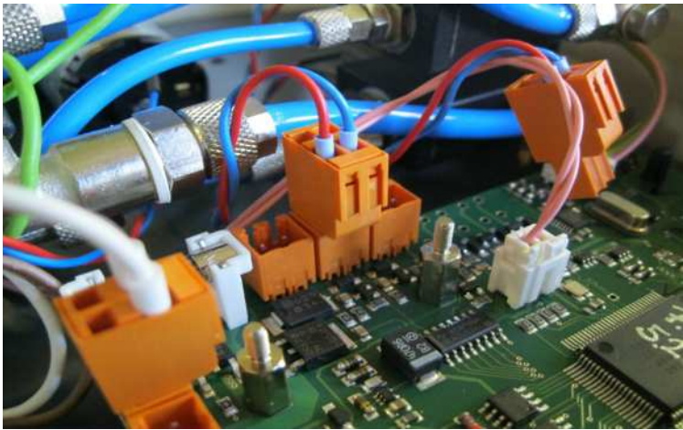
Рисунок 2 – Внутренняя плата уровнемера PS-LIGHT-II с отключенными вилками питания воздушного компрессора и клапана
