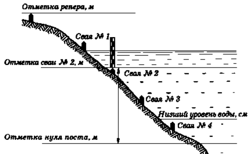
Рисунок 3.1 - Схема высотного положения устройств для измерения уровня воды относительно нуля поста
