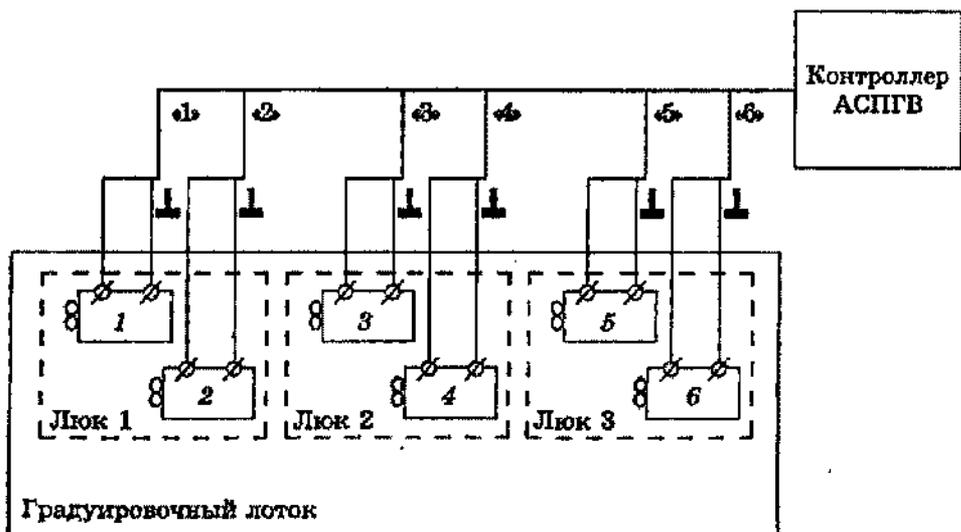
1, 3, 5 — эталонная вертушка; 2, 4, 6 — рабочая вертушка; «1»—«6» — номер сигнального провода
