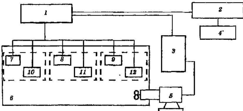
1 — контроллер, 2 — компьютер IBM PC/AT, 3 — тиристорная станция, 4 — принтер, 5 — электропривод, 6 — градуировочный лоток ГР-19М, 7—9 — эталонные вертушки, 10—12 — поверяемые вертушки
