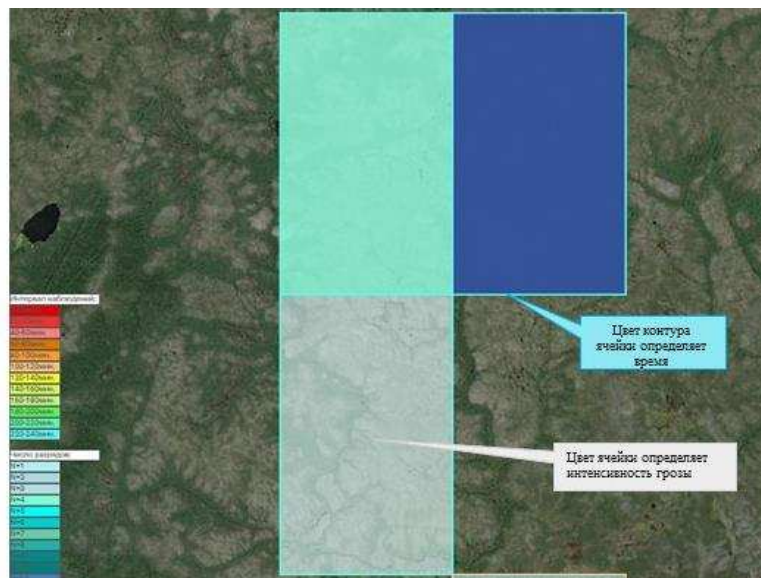
Рисунок 5.2 — Определение принадлежности ячейки к временному интервалу (цвет контура ячейки) и интенсивности грозы (цвет ячейки) по шкале цветности.
