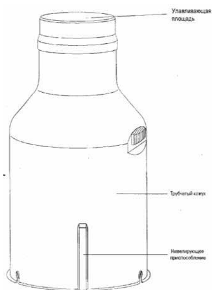
Рисунок 2 – Трубчатый (защитный) кожух осадкомера ОТТ Pluvio 2 200
