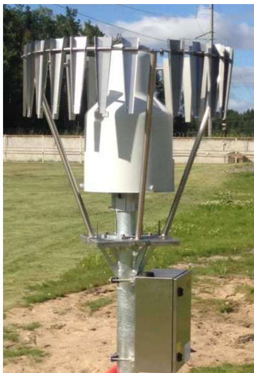
Рисунок 1 – Осадкомер ОТТ Pluvio 2 200 в ветровой защите Альтера
