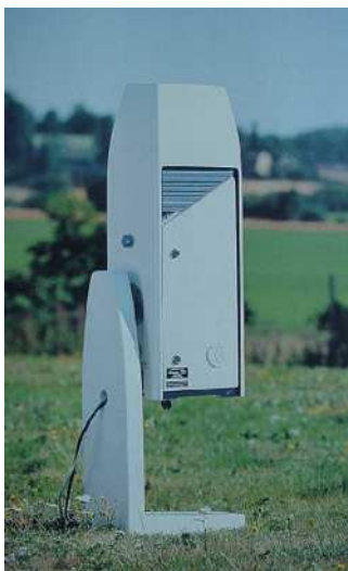
Рисунок А.21 — Датчик высоты облаков СТ25К
