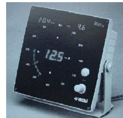
Рисунок А.20 — Многоканальный дисплей параметров ветра WIND30
