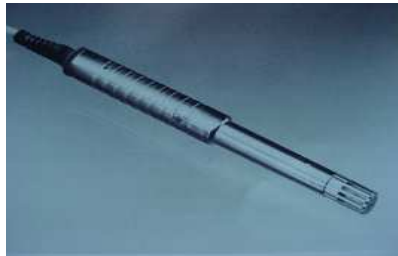
Рисунок А.15 — Датчик температуры и влажности HMP45D (HMP35D)
