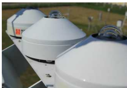
Рисунок 10 – Размещение на следящей системе пиргелиометра (слева), пиранометров и пиргеометра (справа)
