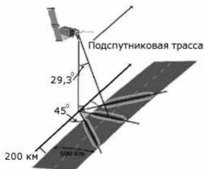
Рис. 2.4.26. Геометрия сканирования ветрового скаттерометра спутника ERS (Gohin, Maroni, 1998).
