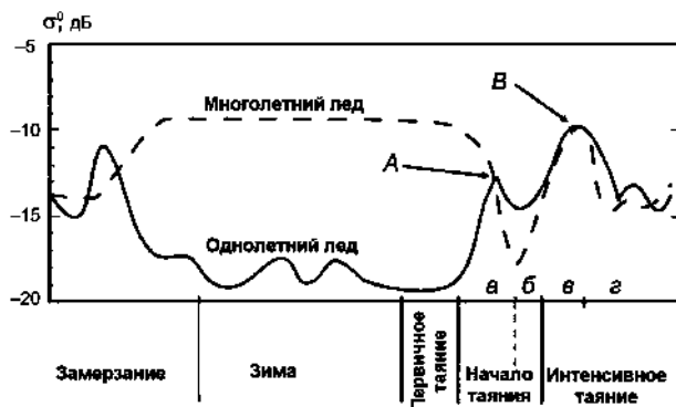
Рис. 2.4.13. Сезонное изменение в пределах годового цикла коэффициента обратного рассеяния в СВЧ-диапазоне (0 дБ) по данным наблюдений SAR C-диапазона с RADARSAT-1 (HH-поляризация) и ERS-1, -2 (VV-поляризация) для толстого ровного неподвижного однолетнего льда и многолетнего льда (Yackel et al. (2007) с использованием работ Livingstone et al. (1987) и Barber et al. (1995)). Буквами А и В указано начало образования снежиц для тонкого (А) и толстого (В) снежного покрова.
