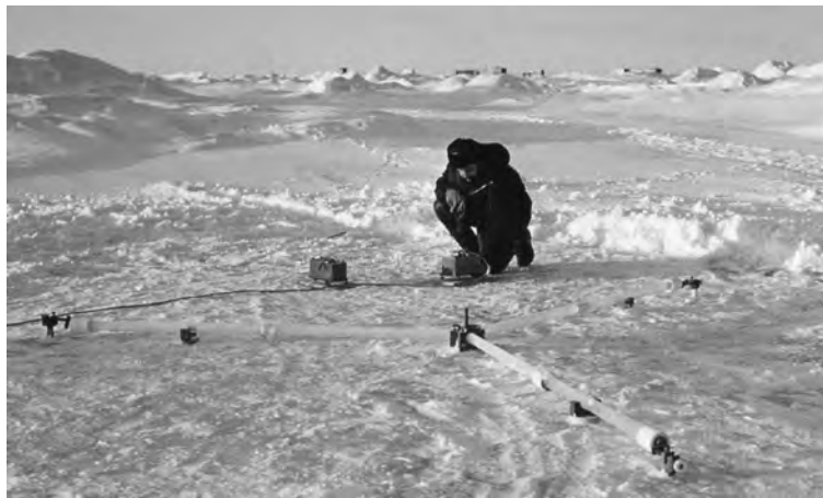
Рис. 2.14. Кварцевый штанговый азимутальный деформометр, установленный на ледяном покрове.
