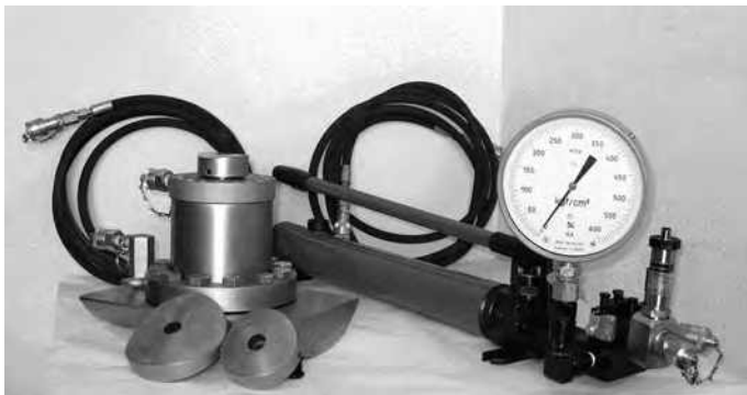
Рис. 2.59. Зонд-индентор гидравлический с ручным гидравлическим насосом.
