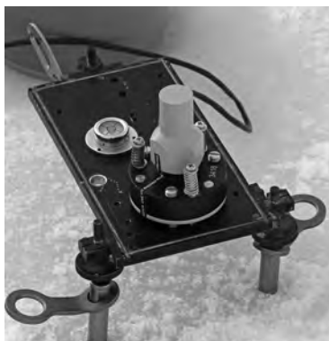
Рис. 2.37. Наклономер ИН-Д3а-360 (720), установленный на ледяном покрове.
