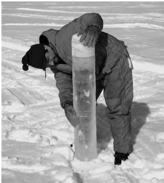
Рис. 2.5. Керн льда, выбуренный на всю толщину ледяного покрова.
