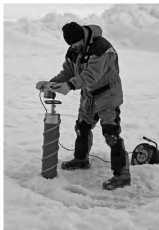
Рис. 2.4. Отбор керна льда керно-отборником “Kovacs Enterprise”.
