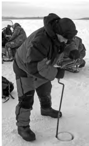
Рис. 2.2. Работа с буром-керно-отборником Черепанова в полевых условиях.
