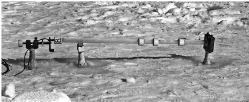
Рис. 2.13. Общий вид штангового линейного деформометра в полевых условиях.
