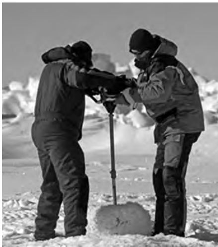
Рис. 2.46. Подготовка скважины шнековым бензобуром для испытания прочности льда зонд-индентором.
