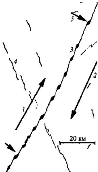
Рис. 1.4. Зарисовка со спутникового снимка протяженной трещины в ледяном покрове с цепочкой разводов по сдвиговому разлому. 1 и 2 — взаимодействующие массивы. Отмечен характерный угол разлома при пересечении протяженных трещин 3 и 4, одна из которых выделена тонкими прерывистыми линиями; 5 — разводья.
