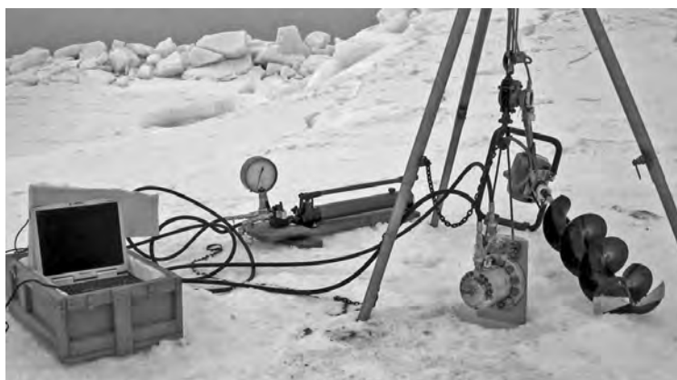
Рис. 2.60. Зонд-индентор с ручным гидравлическим насосом и системой записи на ноутбук, развернутый на подошве стамухи.
