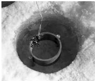
Рис. 2.17. Кольцевой многофункциональный деформометр, развернутый на ледяном покрове.
