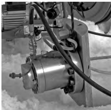
Рис. 2.43. Зонд-индентор для определения прочности ровного льда и консолидированного слоя в торосах и стамухах при проведении испытаний в скважинах.
