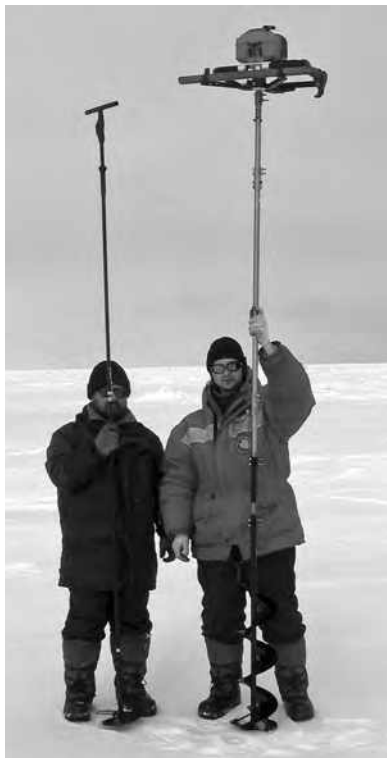
Рис. 2.48. Шнековый бур и очиститель скважин в собранном виде с удлинителями.
