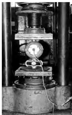
Рис. 2.21. Сферический датчик давления, установленный в прессе для точечной калибровки.
