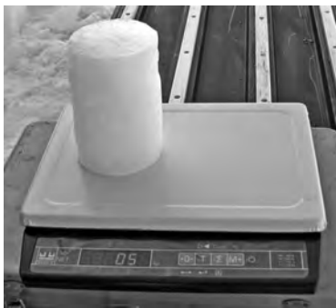
Рис. 2.10. Взвешивание образца льда для определения плотности на электронных весах в полевых условиях.
