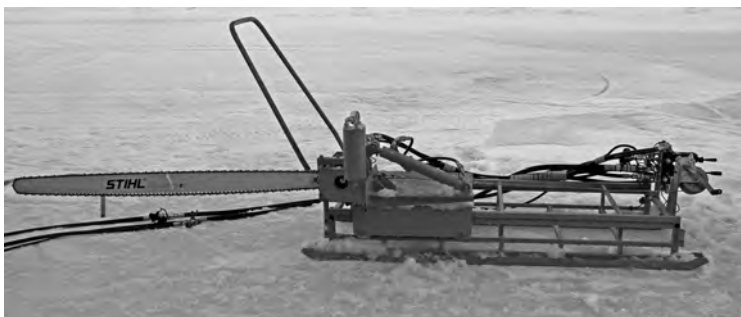
Рис. 2.66. Гидромеханическая цепная пила для вырезания консольных балок и блоков льда.
