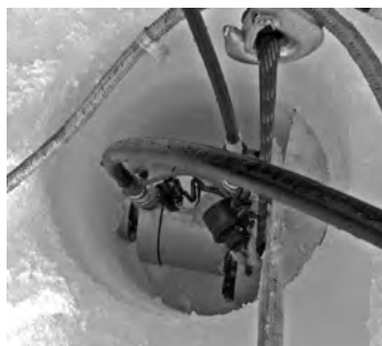
Рис. 2.52. Зонд-индентор, установленный в скважине.
