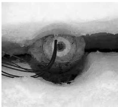
Рис. 2.28. Сферический датчик давления, установленный во льду.
