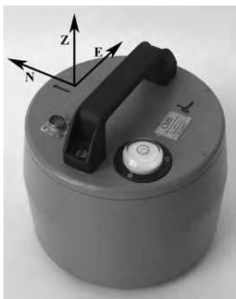
Рис. 2.50. Направление осей чувствительности сейсмометра СМЕ-4311.
