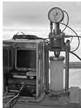
Рис. 2.55. Пресс для испытаний образцов льда, развернутый в полевых условиях.
