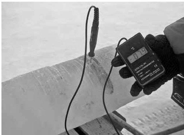
Рис. 2.9. Измерение температуры в керне льда.
