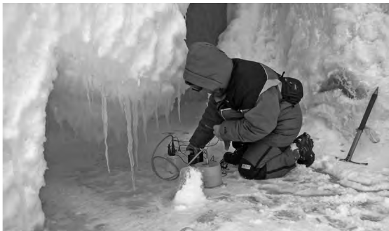
Рис. 2.34. Развертывание сейсмометра СМЕ-4111LT с накопителем информации «Байкал-7HR» на льду у подножья айсберга.
