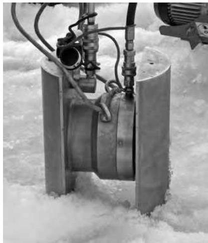
Рис. 2.45. Зонд-индентор с сегментным индентором для определения характеристик прочности паруса и киля торосов.
