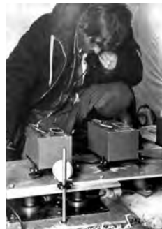
Рис. 2.29. Калибровка наклонмеров на специальной гидравлической платформе.
