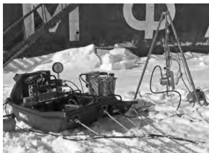
Рис. 2.51. Комплексная система для определения характеристик прочности льда в скважинах в натуральных условиях.
