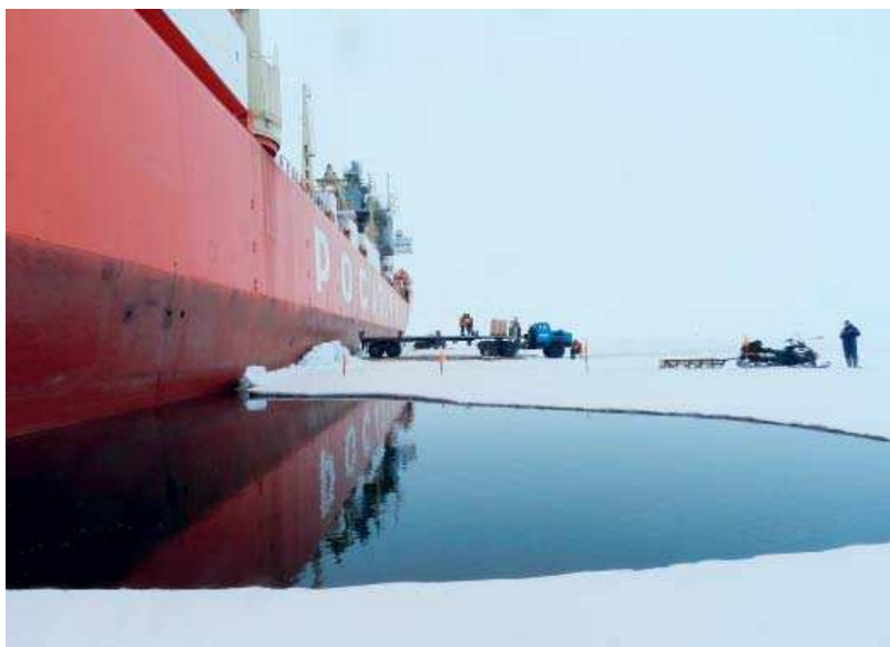
Рис. 31. Вытаивание льда у борта в результате выхода тепла от системы охлаждения ядерного реактора.
