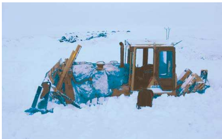
Рис. 19. Бульдозер, застрявший в снежно-водной «каше».
