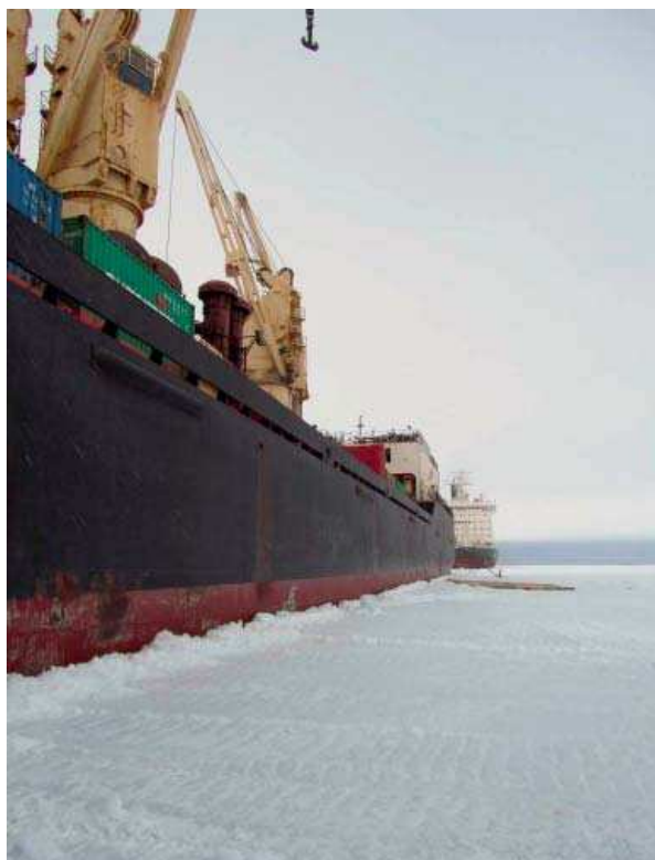
Рис. 22. Состояние льда у борта судна после заделки в заранее подготовленные пропилы.
