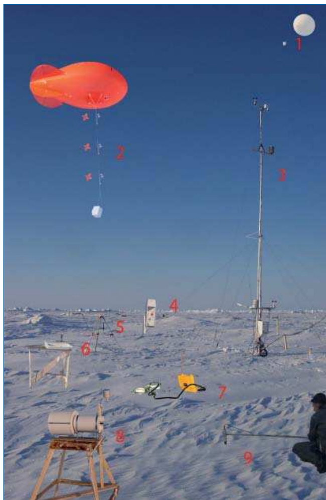
Рис. 1. Комплекс аппаратуры для метеорологических и аэрологических исследований на дрейфующих станциях «Северный полюс»: 1 – радиозондирующий комплекс, 2 – аэростатный комплекс, 3 – метеоактинометрический комплекс, 4 – измеритель высоты нижней границы облачности, 5 – установка для проведения актинометрических наблюдений, 6 – измеритель общего содержания озона, 7 – установка для измерения потока углекислого газа, 8 – метеорологический температурный профилер, 9 – малогабаритный спектрометр.
