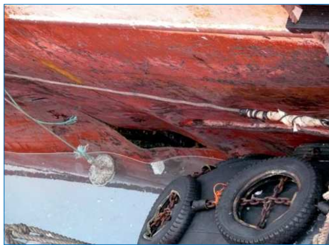
Пробоина правого борта, после откачки топлива и кренования. 26 декабря 2011 г.
