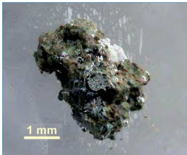
«Крупное» включение донных осадков озера, захваченное озерным льдом (глубина 3607 м), предположительно содержащее газовый гидрат. Фото В.Я.Липенкова.
