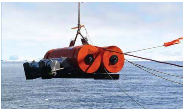
Сейсмобуй перед погружением. Прибор может фиксировать волны цунами и подвижки земной коры.
