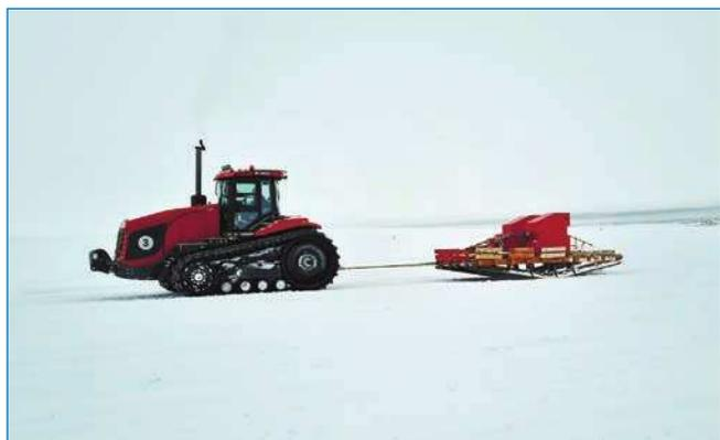
Уплотнение снежного слоя с помощью уплотняющей платформы
