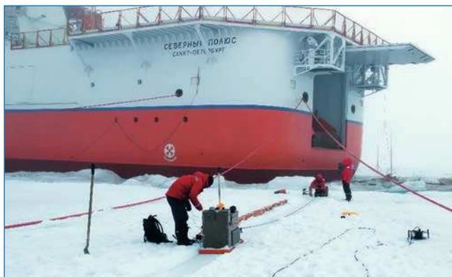
Выполнение эксперимента по определению коэффициента трения у борта ЛСП «Северный полюс». 22 июля 2023 года
