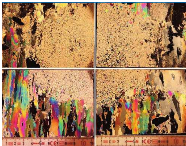
Рис. 10. Структура зоны разрушения перпендикулярно направлению внедрения индентора на горизонте 30 см, 21 июля 2023 года
