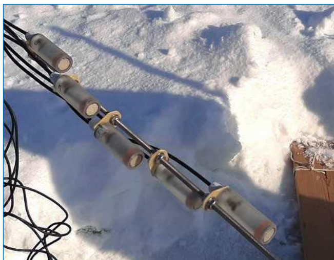
Рис. 25. Пример линейки пьезокерамических датчиков, закрепленных через 10 см на металлическом пруте, предназначенных для вмораживания в ледяной покров
