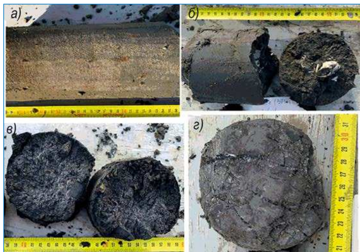
Рис. 3. Керна из скважины № 1: а — песок мелкий с массивной криотекстурой, глубина 0,65–0,90 м; б — песок пылеватый с массивной криотекстурой и раковинами моллюсков, глубина 3,35–3,50 м; в — налет соли в легком суглинке с массивной криотекстурой, глубина 4,25 м; г — сетка из вертикальных шпиров в пылеватом суглинке, глубина 10,2 м
