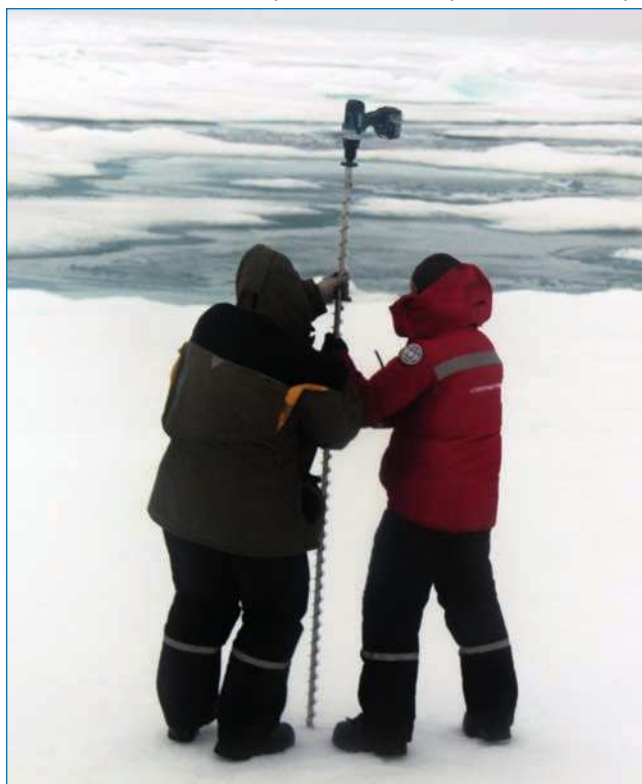
Рис. 4. Промер толщины льда. Фото М.А. Емелиной
