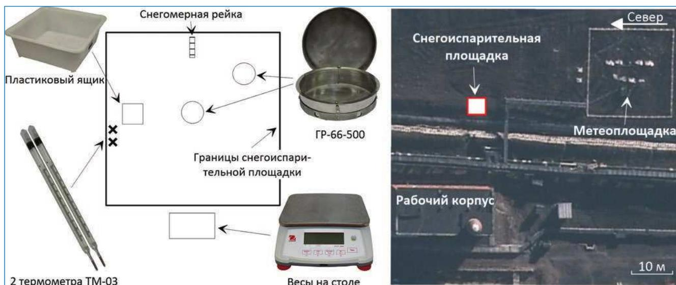
Схема размещения снегоиспарительной площадки и ее наполнения
