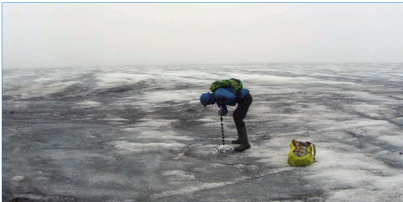
Бурение скважины во льду для абляционной рейки
