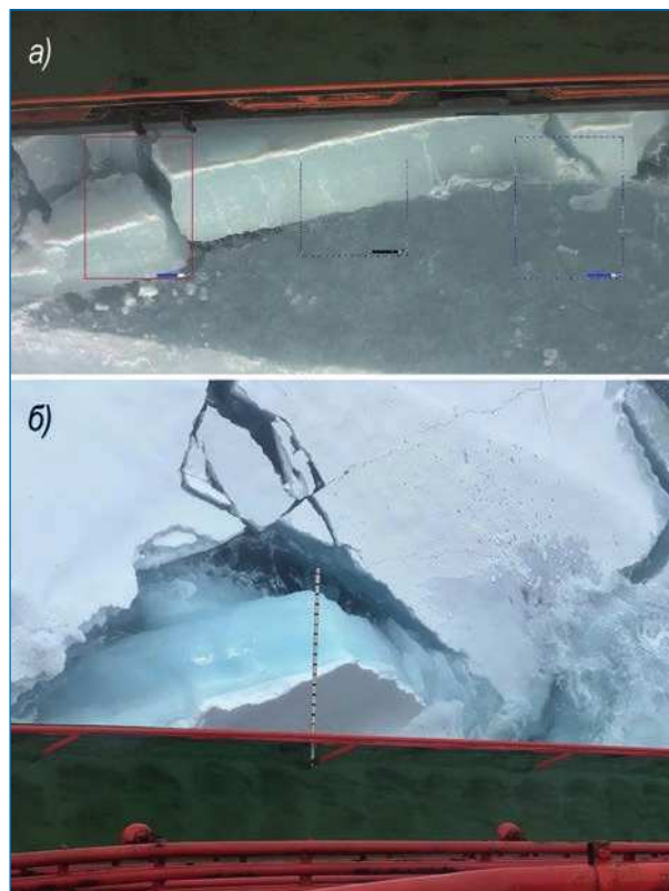
Рис. 2. Пример изображения СТК, установленного на кронштейне с правого борта атомного ледокола «50 лет Победы» (а) и проведение визуальных судовых наблюдений за толщиной льда с использованием ледомерной рейки, закрепленной на палубе бака (б)
