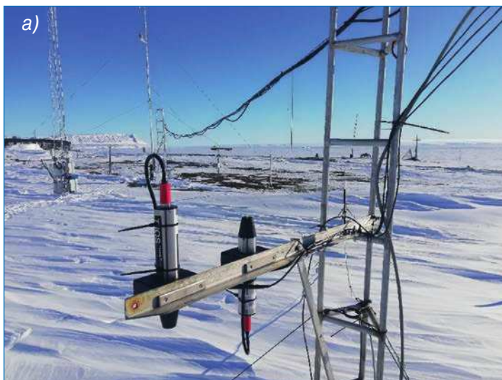
Рис. 2. Датчики на территории метеоплощадки НИС: а) крепление на штанге датчиков приходящей и отраженной солнечной радиации; б) общий вид стойки и подстилающая поверхность под датчиками после снеготаяния
