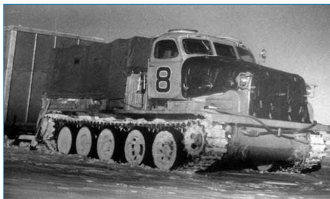
«Восьмерка» — один из тягачей 2-й КАЭ. Видно утепление капота
