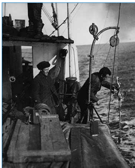
Опускание гидрографической вертушки для определения скорости и направления течения. Море Лаптевых, сентябрь 1937 года. РГМАА
