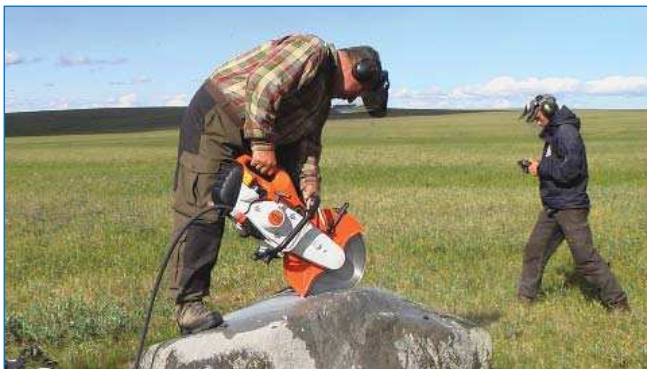
Отбор образца из валуна долерита для определения возраста появления камня на поверхности
