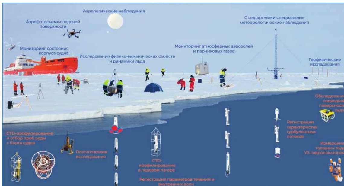
Рис. 2. Организация научных исследований в ледовом лагере дрейфующей станции, проводимых в формате «судно — лед»
