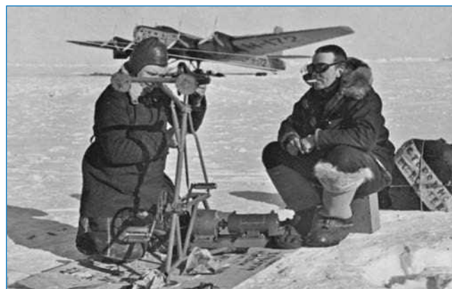
Сборка двухколлекторной динамо-машины типа РМ-2 с комбинированным ножным и ручным приводом
