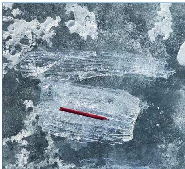
Рис. 4. Характерная структура пористого льда с вертикальными кавернами из нижней части ледяного покрова оз. Аэрогеодезии
