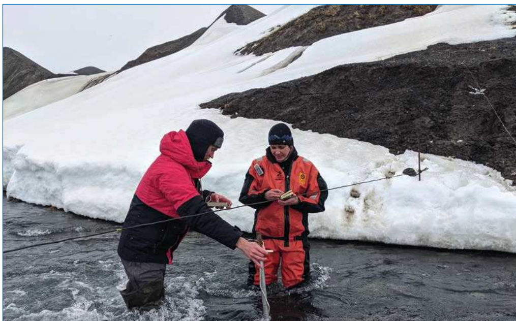
Измерение стока воды на реке Бретьерна, июнь 2021 г. Фото К.В. Ромашовой
