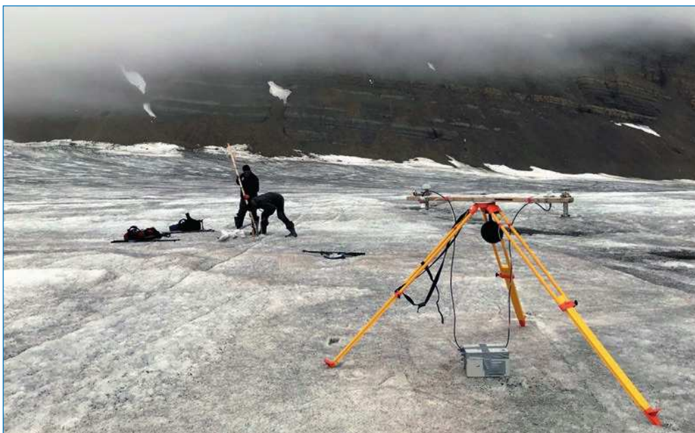
Временная теплобалансовая установка и проверка абляционной рейки в рамках комплексного мониторинга таяния ледника Альдегонда, июль 2021 г. Фото У.В. Прохоровой
