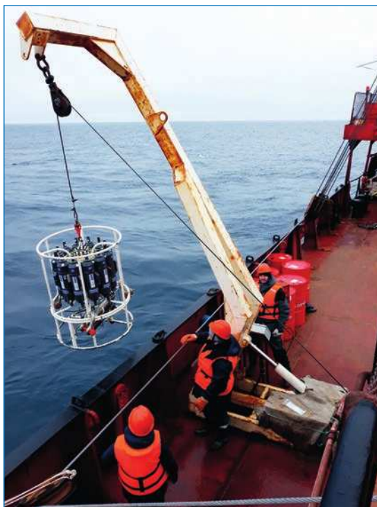
Работа с пробоотборным комплексом SBE 32. Фото А.М. Безгрешнова
