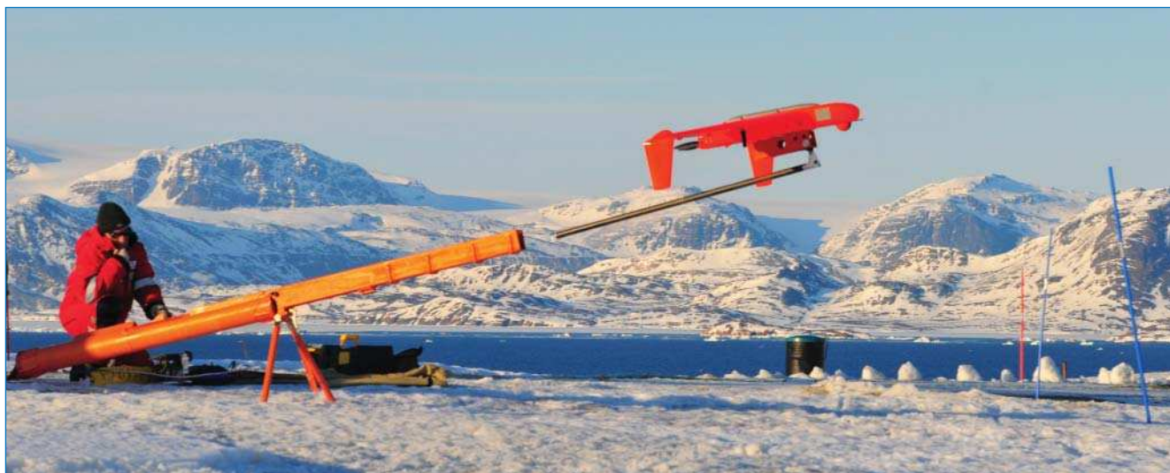
БЛА «Элерон-10Э» в момент старта. Оператор катапульты – А.Э.Клейн. Фото К.С.Йохансена (NORUT)
