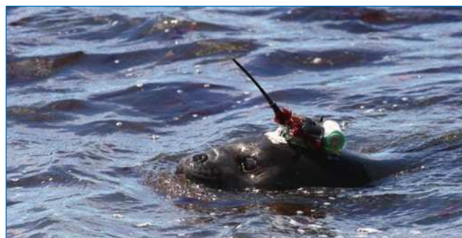
Южный морской слон с установленным датчиком CTD-SRDL. Фото Кристоф Гине (Christophe Guinet)
