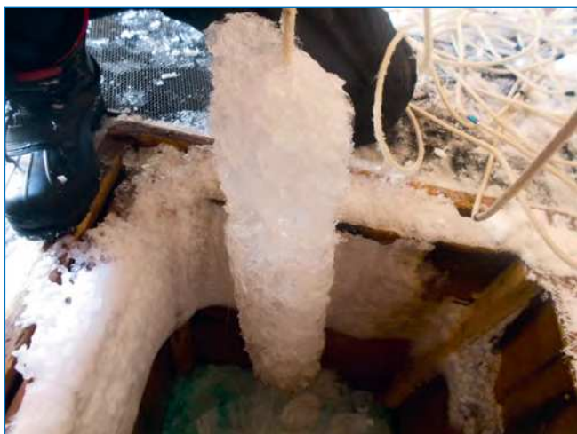
Обрастание фала пластинками внутриводного льда
