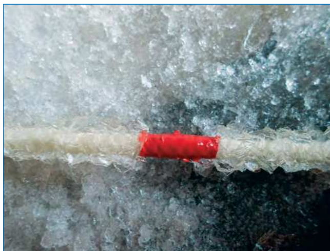
Фал, обмотанный ПВХ-лентой
