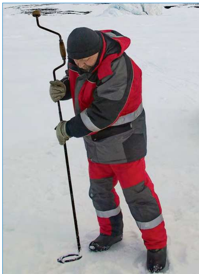
Рис. 4. Бурение льда кольцевым буром Черепанова
