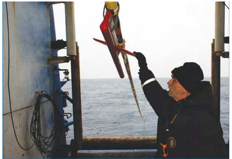
Устройство контроля глубины DigiBIRD на сейсмической косе DigiSTREAMER. Фото А.Ю. Казанкова.
