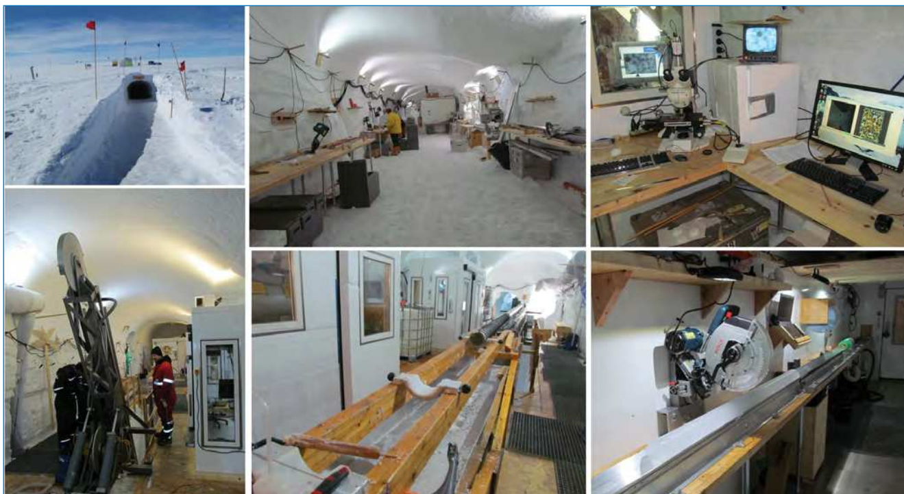
Подземные конструкции EastGRIP. Верхний ряд: вход; научная траншея, где ведется обработка керна; изучение физических и кристаллографических свойств образцов вновь пробуренного ледяного керна. Нижний ряд: буровая вышка в действии; буровая колонка после извлечения керна; первичная обработка ледяного керна. Фото Д.О. Владимировой.
