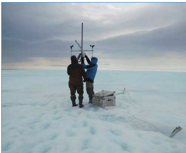
Установка автоматической метеостанции на леднике Мушкетова. Фото Д.Ю. Большаинова
