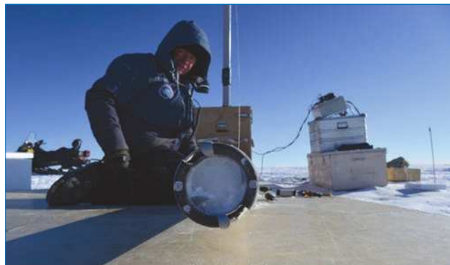
Рис. 4. Скважина VK19. Буровой снаряд с вновь добытым кернам поднят на поверхность. Фото А.Н. Верес
