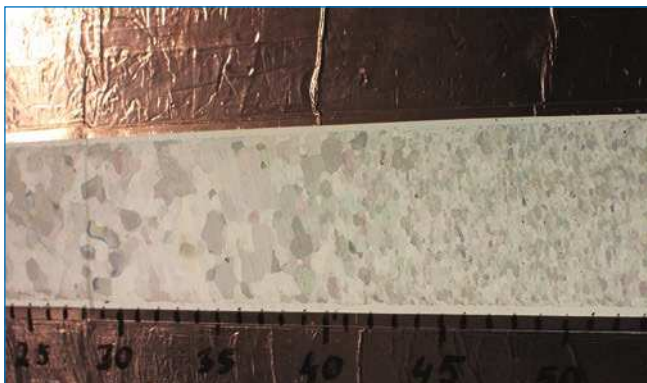
Рис. 3. Резкое изменение размера кристаллов керна 5Г-5 на глубине 3318 м. Фото А.А. Екайкина
