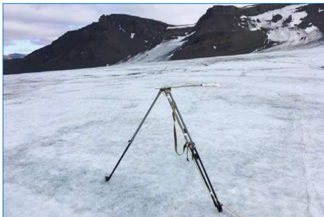
Радиометр CNR-4 на леднике Альдегонда
