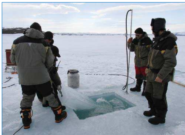
Вырезка майны водяным ледорезом. Фото В.А. Бородкина.
