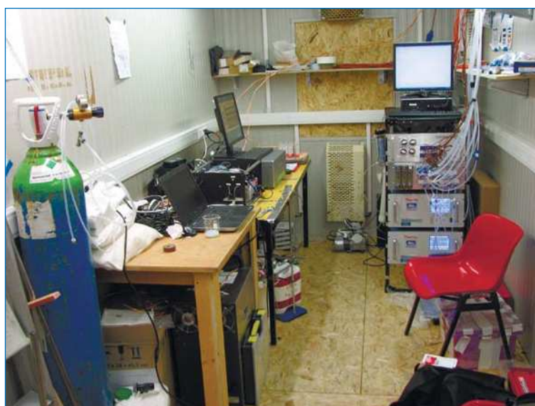
Установка для измерения изотопного состава водяного пара атмосферы.
